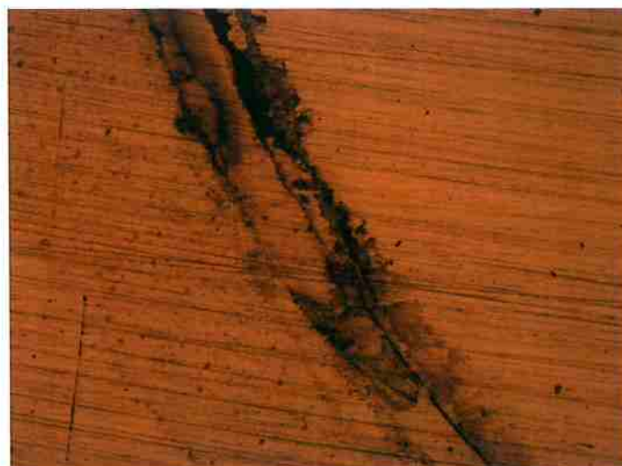
Figura 24. Corrosão do aço na região próxima ao anel de vedação, obtida em microscópio óptico com 50X de aumento.
