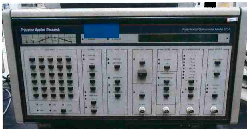
Figura 6. Potenciostato da EG&G Princeton Applied Research, modelo 273A.
