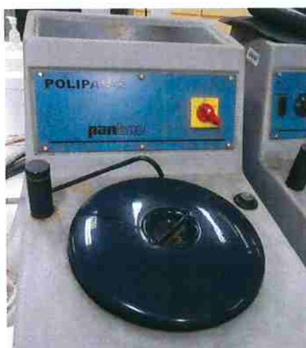
Figura 2. Lixadeira da Pantec, modelo Polipan-2.
